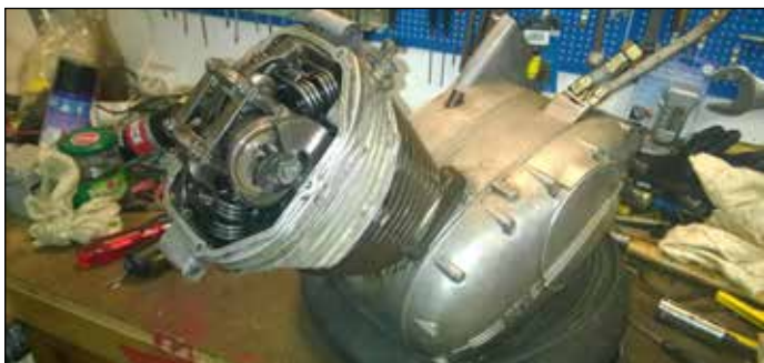
Under: Sylinder, topp og kamaksel montert
