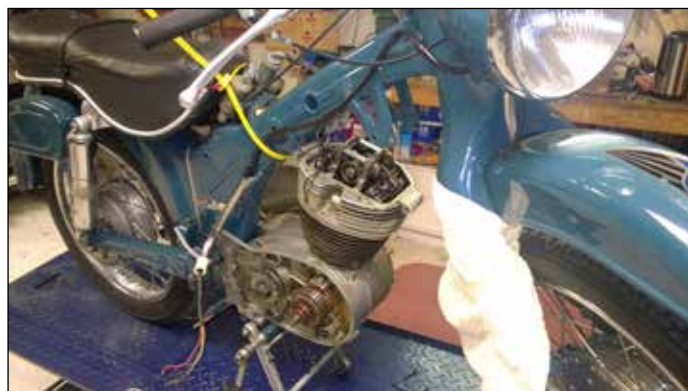
Over: Motor på plass i ramma.
