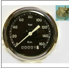
Veigel-Tachometer 601 OSL Meßbereich 160
